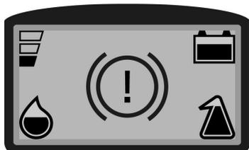
左記のイメージは、「電磁ブレーキがOFF」状態を示しています。
