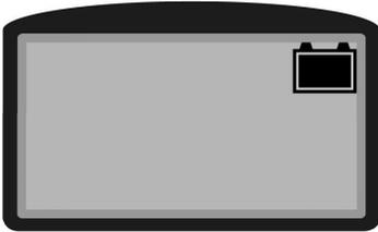
左の画像は“操作パネル”スクリーンで、右上のアイコンはバッテリー残量を表示します。
