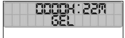
9. 3番目と最後の画面（「ワーク」と呼ばれる）には、バッテリーの充電状況と合計機能時間が表示されます。供給されたバッテリーが完全に充電されると、ボトムラインにバッテリーを表す 10個のランプが表示されます。電池が徐々に消耗すると、インジケータが消え、電池が完全に消えて電池の外形だけが点滅します。一番上の行は、機能している時間と分を示します。点滅する ":"記号時間計が機械の機能時間をカウントしていることを示します。
